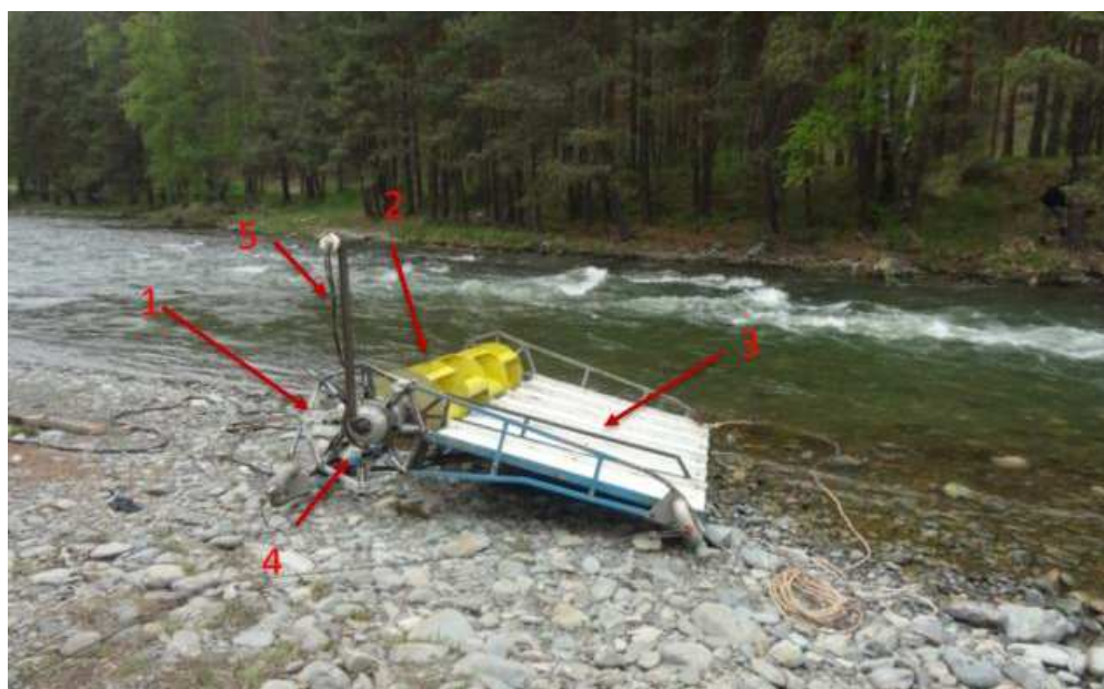
Rys. 12. Konstrukcja małej elektrowni wodnej pogrążanej w nurcie rzeki przy dnie, o mocy 1,3 kW. [7]
